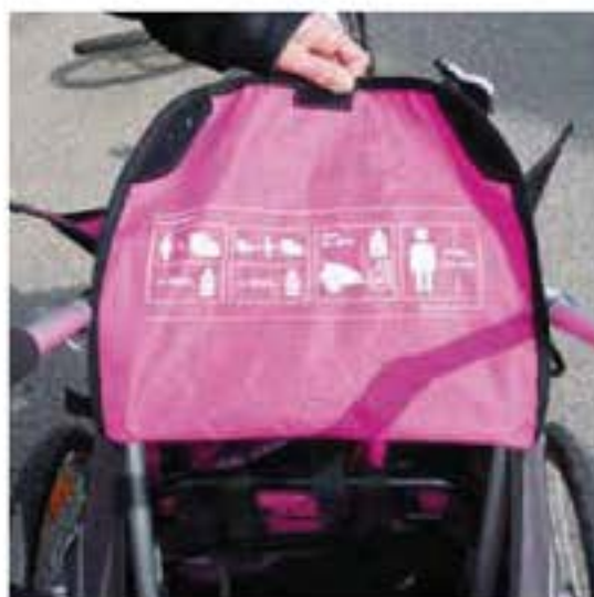
Ve vozíku Azub Jerry hrozí kvůli nevhodné konstrukci možný kontakt dítěte s kolem.
